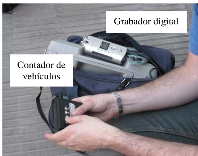
Figura 3: Contador electrónico de vehículos y grabador digital H4.
